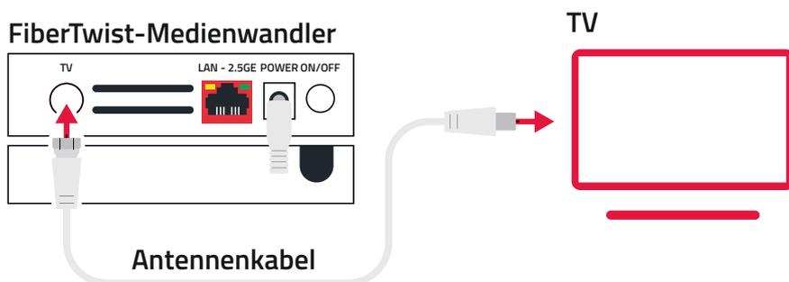
**Hinweis:** Installieren Sie die mit dem FiberTwist-Medienwandler erhaltenen Adapter am Medienwandler entsprechend der dort beiliegenden Anleitung.
