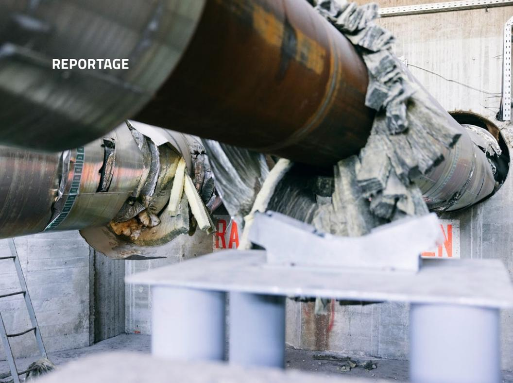
Zerborstene Fernwärmeleitung im Brückenkopf der Carolabrücke: Das Stahlrohr riss hier wie ein Stück Papier
